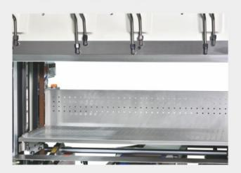
产品堆叠高度: 0-350mm,配备自动升降堆叠产品的结构设计,对轻小产品的堆叠也无忧,平稳堆叠并计数,快速水平推出产品至流水线,由流水线输送架送至包装的位置,有利于快速包装。
