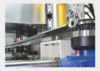
不伤片材,防止生产过程中产生塑料粉尘,适用于高品质制品,达到无尘车间生产标准。链轨可扩张0~60mm,选用片材宽向兼容性强;平行拉伸,使片材均衡伸展,边料少,约15mm左右,节省材料。
