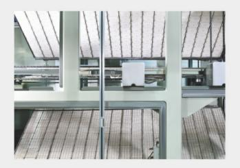
电炉配备德国高效节能陶瓷发热瓦,高频瓷接头,上下炉两段加热,电炉结构紧凑,由气缸驱动呈八字形张开,减小空间占用面积.炉区有隔热挡板机构,加热区片材长度范围可根据生产需求来进行调节。
