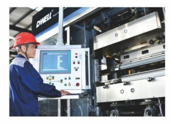
控制系统为人工智能。操作控制箱采用专业制作铝合金吊箱式,控制系统采用三菱可编程控制器,研华15寸彩色工控机,由SSCNET III/HI光纤通讯控制三菱伺服,定位快速精准。专业的操作画面与远程连机,解决了远程维护与程序升级问题,并具有强大的内存空间,设置包含:手动操作、自动操作、成型模式、运动参数、温度设定、报警记录、维护指引、配方数据储存和U盘备份,整套系统安全稳定,易操作。
